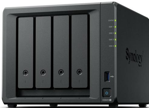
Synology DiskStation DS925+. Tipo: NAS, Classe del dispositivo: Casa e piccoli uffici. Famiglia processore: Ryzen Embedded, Modello del processore: V1500B, Frequenza del processore: 2,2 GHz. RAM installata: 4 GB, Tipo di RAM: DDR4. Capacità di archiviazione totale installata: 0 TB
